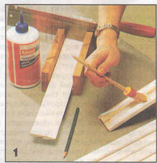
Щиты-заготовки для дверок размечают по высоте, раскраивают по ширине дверки верхнюю и нижнюю завершающие планки и приклеивают их к щитам.
