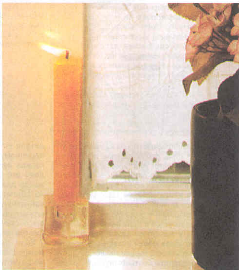
Наличие сквозных щелей можно определить по отклонению пламени свечи или дыма сигареты.
